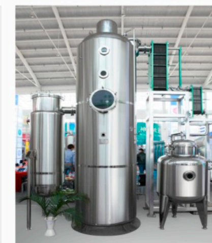
Concentrador de vácuo com condensador de placas de circulação externa de efeito simples DJT DJT single-effect external circulation plate type condensing vacuum concentrator
