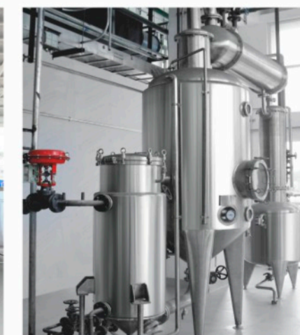
Concentrador de vácuo de circulação externa de efeito simples DJTS (tipo automático à prova de explosão) DJTS single effect external circulation vacuum cream reclaim concentrator
