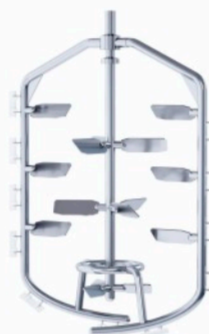
Agitação dupla com pá externa e propulsão interna Outer Frame Type Blade Internal Propulsion Type Double Agitator
